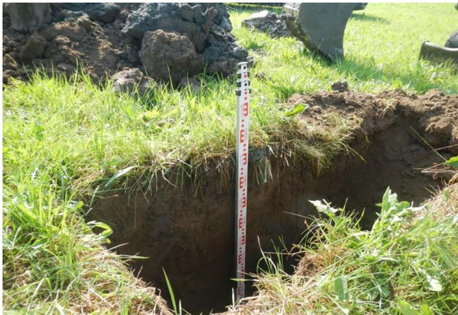
**Abbildung 2: Schurfgrube 5 konnte bis auf eine Tiefe von 1,8 m niedergebracht werden**
